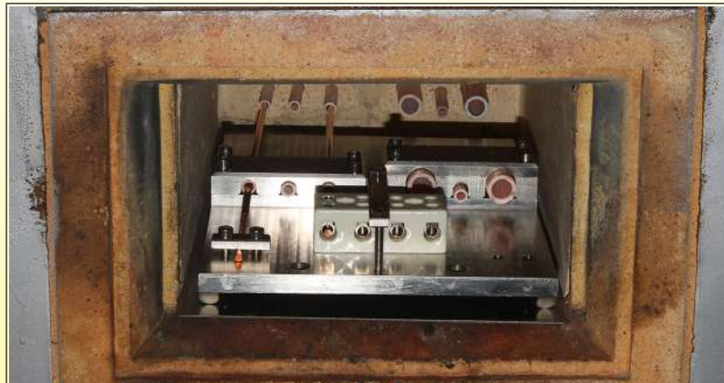
Forno di test per la resistività della ceramica in funzione della temperatura (Laboratorio Ultimheat)
