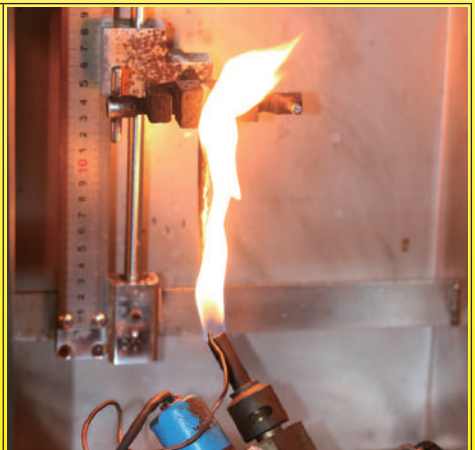
Campione durante il controllo UL94VO
